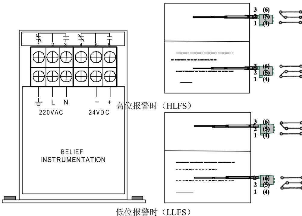
图 4.6 电源及继电器接线图
