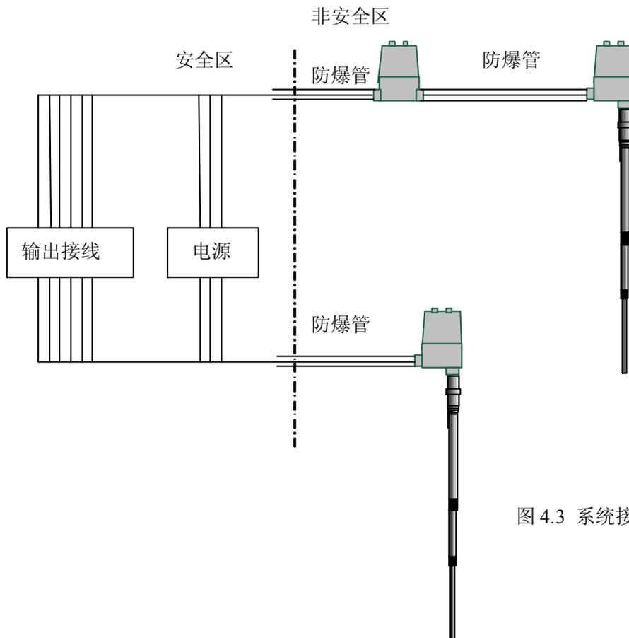
图 4.3 系统接线图
